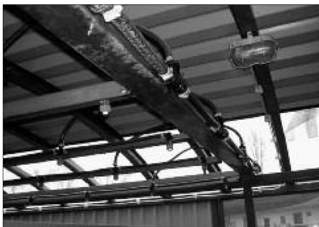
5. kép: Permetkamra állványzata a vízvezetékcsövekkel és szórófejekkel
