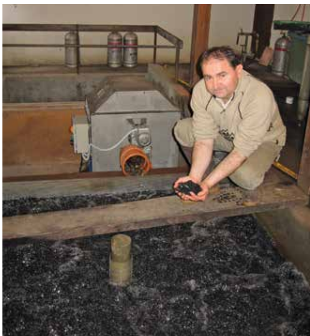
Az első modern szűrőrendszer (dobszűrő, mozgó ágyas bio-filter)
