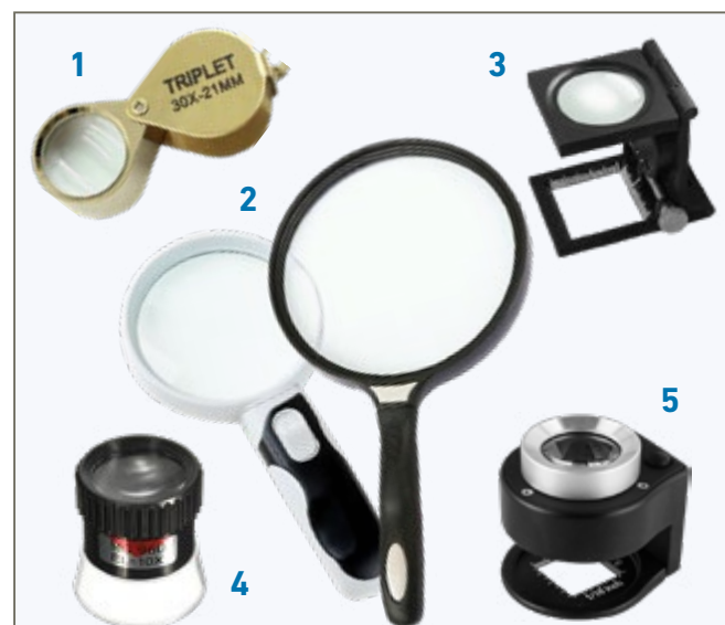
1) Ékszerészlupe. 2) Kézi nagyítók. 3) Összecsukható talpas textillupé mm beosztással. 4) és 5) Állványos nagyítók.
